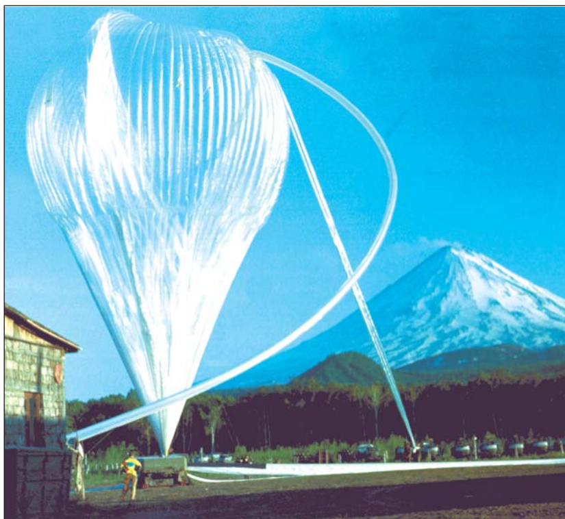
Подготовка аэростата к запуску. Идет закачка газа по специальным рукавам.
